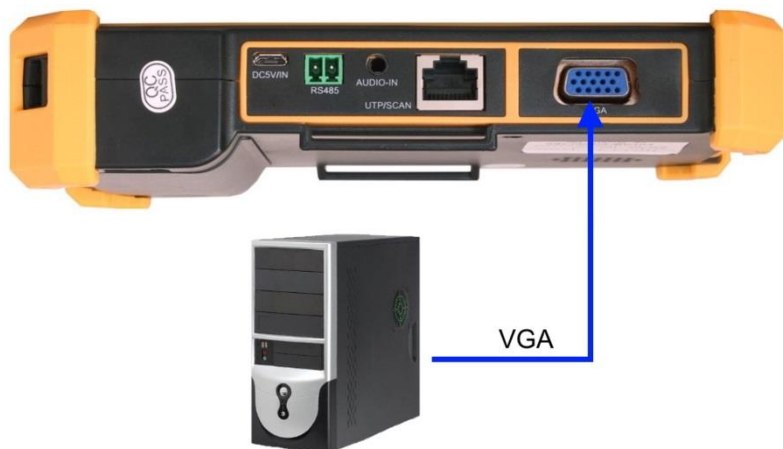
Рис.14 Подключение устройств к VGA входу тестера
