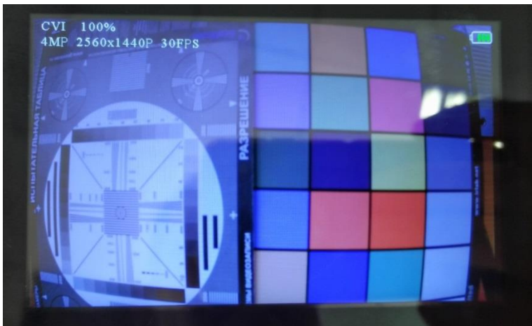
Рис.8 Изображение с видеокмеры на экране тестера TSH-H-5
