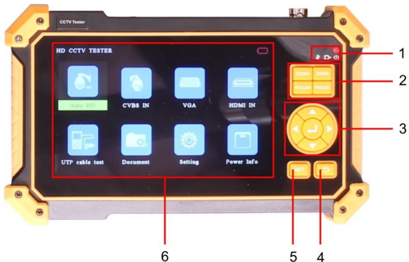
Рис.3 Тестер TSH-H-5, кнопки и индикаторы передней панели
