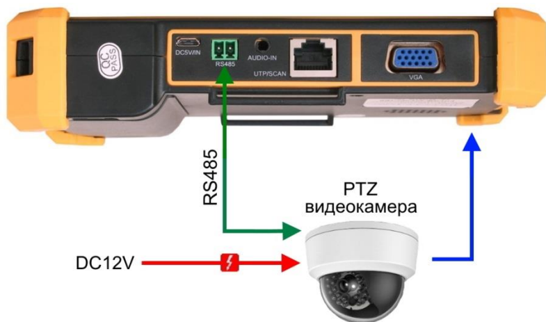
Рис.9 Подключение PTZ видеокмеры к тестеру
